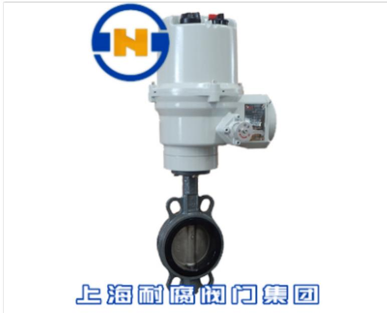
蝶阀是指关闭件(阀瓣或蝶板)为圆盘,围绕阀轴旋转来达到开启与关闭的一种阀,在管道上主要起切断和节流作用。蝶阀启闭件是一个圆盘形的蝶板,在阀体内绕其自身的轴线旋转,从而达到启闭或调节的目的。蝶阀全开到全关通常是小于90°,蝶阀和蝶杆本身没有自锁能力,为了蝶板的定位,要在阀杆上加装蜗轮减速器。采用蜗轮减速器,不仅可以使蝶板具有自锁能力,使蝶板停止在任意位置上,还能改善阀门的操作性能。
